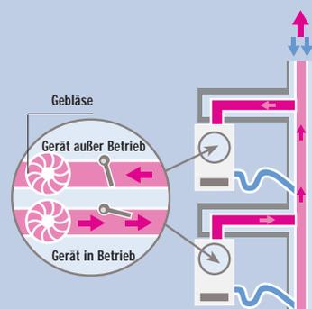
Die Mehrfachbelegung funktioniert als Überdrucksystem. So kann die verfügbare Querschnittsfläche des Schornsteins gleichzeitig für Abgas und Verbrennungsluft genutzt werden. Um zu verhindern, dass bei nicht betriebenen Brennwertgeräten Abgas austreten kann, arbeitet der Logamax plus GB132 mit einer speziellen Rückströmsicherung.
